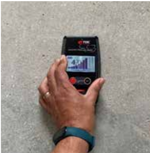
Figura 3 – Aparelho para medir o percentual de umidade do concreto.
