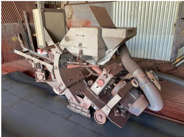
Equipamento de jateamento turbina de circuito fechado
